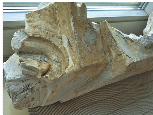
Сохранившийся фрагмент маски льва, использованный для масштабирования при восстановлении по архивным фотографиям
