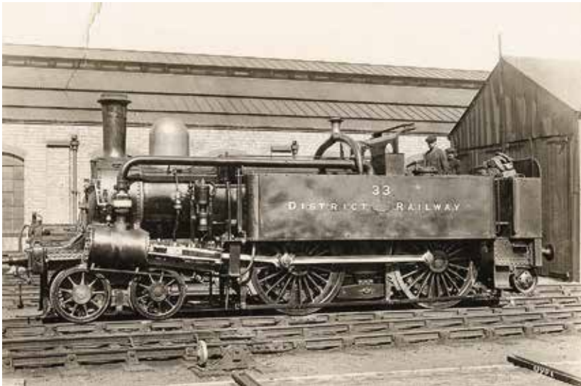
(1) Паровоз Veyer Reaосск лондонской подземки с пароконденсатором. 1864
