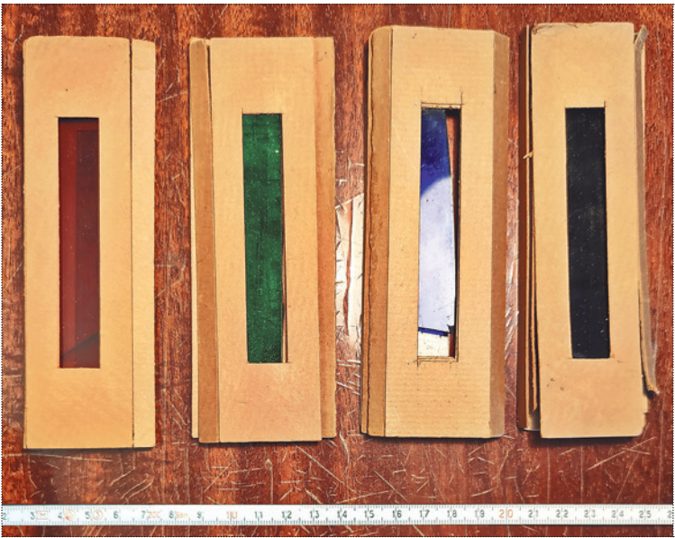
Шкала цветных накладных стёкол, с которыми работал Г.А. Ечеистов. 1938 год. Завод «Красный гигант». Фото: Т.В. Княжицкая, 2023 год. Из коллекции семьи Ечеистовых. Публикуется впервые
