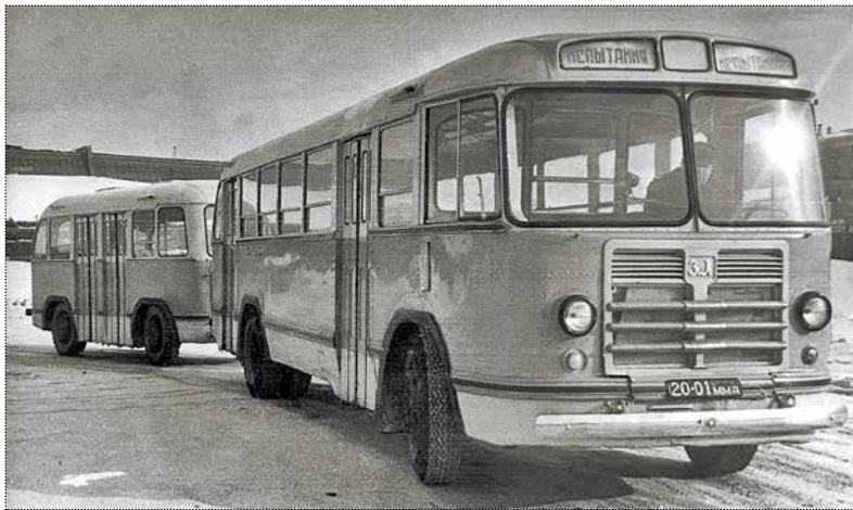
Испытания автобусного поезда, состоящего из тягача ЗИЛ-158 и прицепа на базе 2-ПН-4 на территории 2-го автобусного парка. Архив М.В. Егорова
