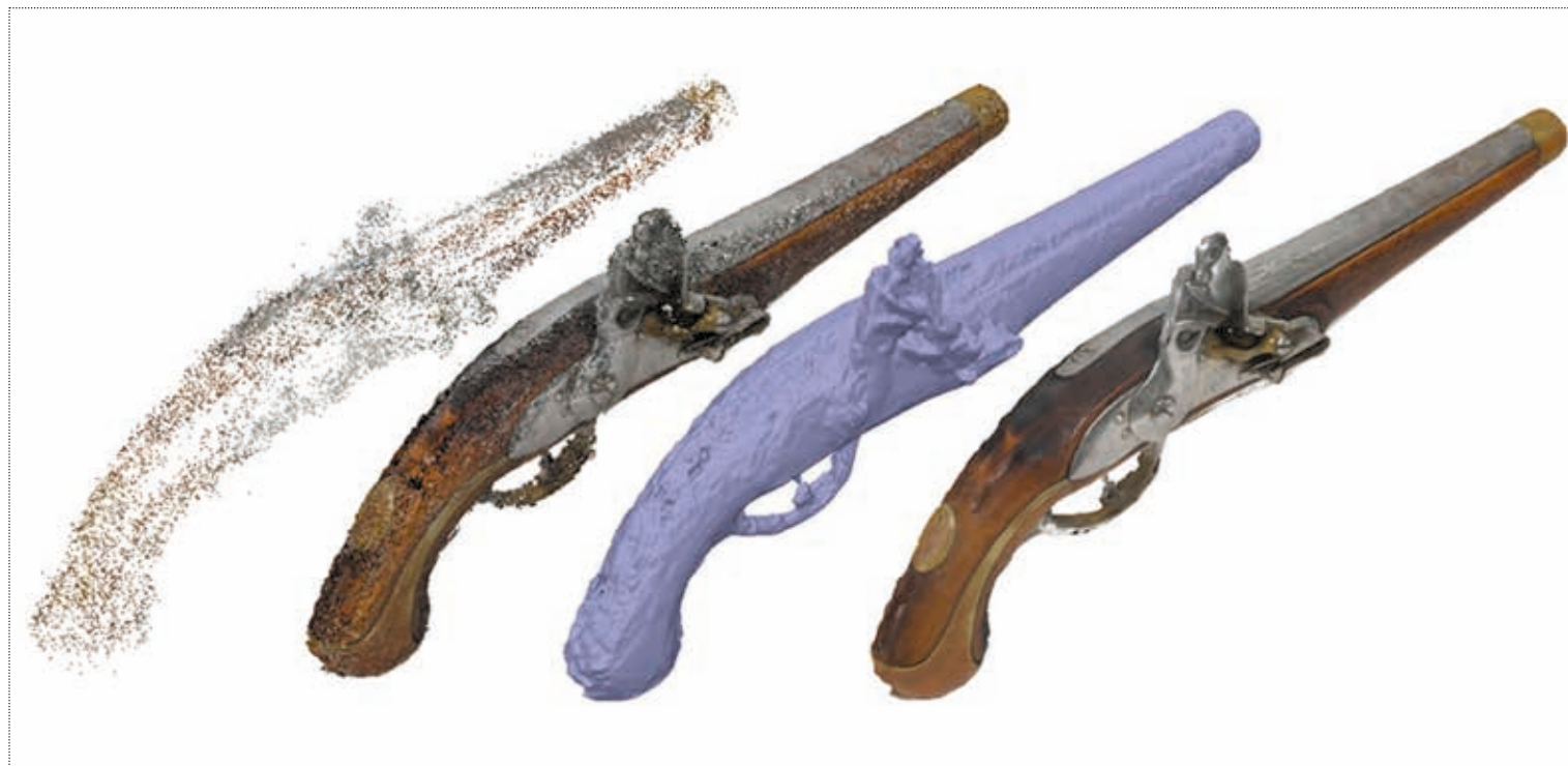
Стадии фотограмметрической обработки пистолета (Тула 1814г.). От облака точек — до полигональной текстурированной модели. Фото автора, 2021 год
