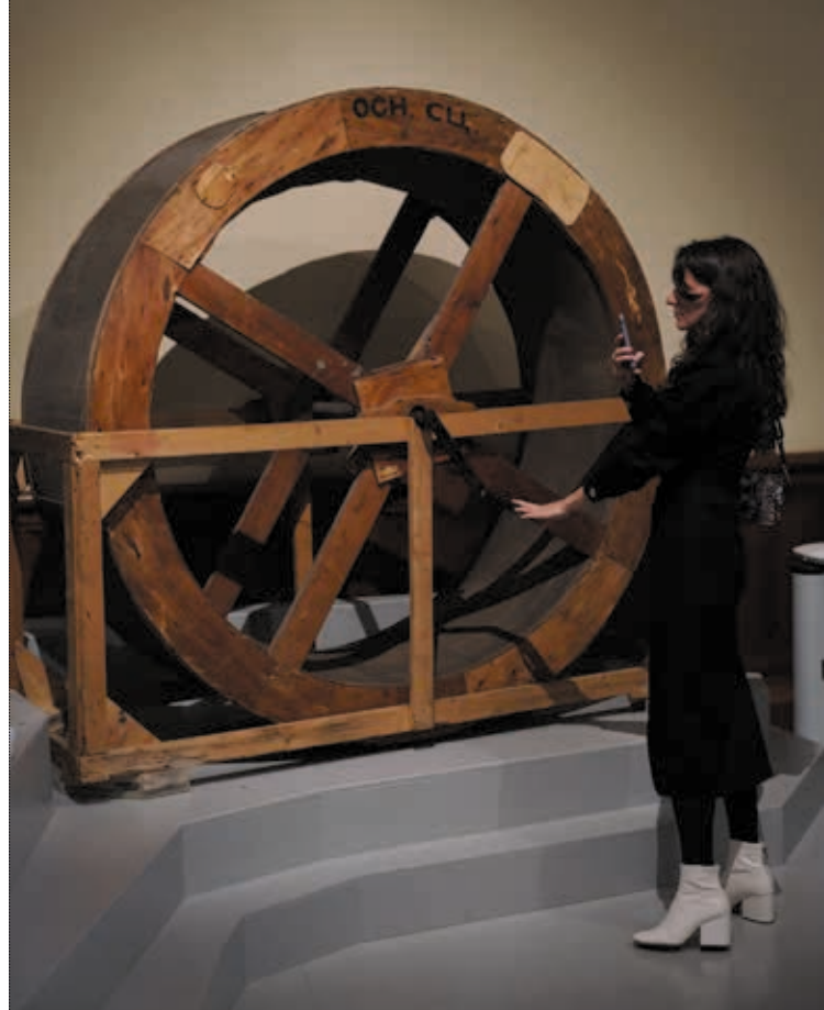
Театральная машина для имитации шума дождя по проекту Владимира Попова (1889–1968). Первая треть XX века. Дерево, металл, кожа, верёвка. МХАТ им. Чехова. Фото: М. Горлов, 2021 год
